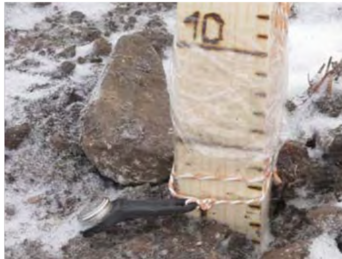
Мобильный регистратор температуры, зафиксированный на снегомерной рейке, («Буртинская степь», декабрь 2014 г.)
