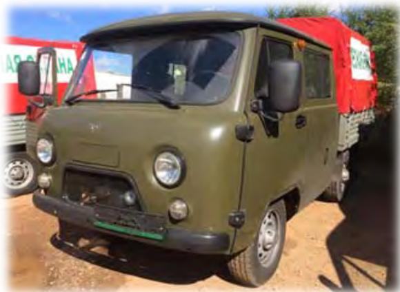
Сегодня на каждом участке сформирован малый противопожарный комплекс на базе автомобиля УАЗ – фермер с комплектом: емкость для воды на 500 л, УПВД, мотопомпа с оснасткой, воздуходувки-опрыскиватели, ранцевые огнетушители, шанцевый инструмент и прочее.
