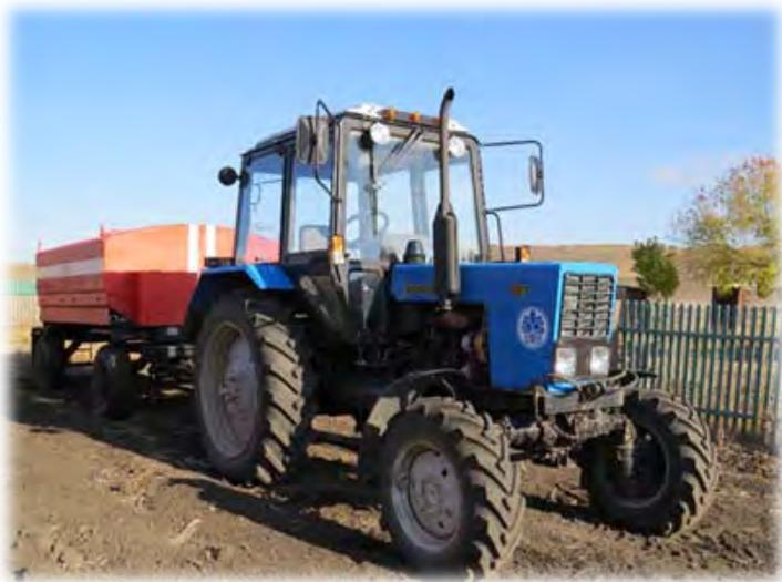
В 2014 году обновлен тракторный парк за счёт приобретения МТС-Е в количестве 4 единиц (трактор МТЗ-82.1 «Беларус», оснащенный передним отвалом, прицепной цистерной для воды на 5 куб.м, вооружением для тушения пожара и погрузочным устройством).
