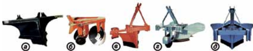
Рис. 9.13. Некоторые модели плугов, используемых для создания минерализованных полос: а – клин-толкатель ТК-1,2; б – плуг ПДП-1,2; в – плуг ПЛ-1; г – плуг ПКЛ-70; д – плуг ПКЛ-70А
