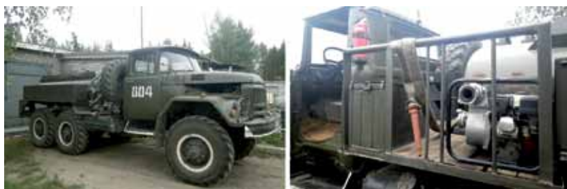
Рис. 9.10. Армейская авторазливочная станция (АРС-14) на базе автомобиля ЗИЛ-131
