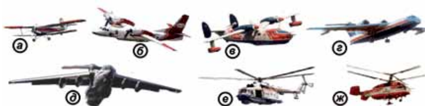
Рис. 9.14. Отечественные модели самолетов и вертолетов, пожарных авиатанкеров, имеющих внутренние емкости для огнегасящего раствора: а – Ан-2П (съемный бак на 1200 л); б – Ан-32П (баки на 8000 л)*; в – Бе-12П (баки на 6000 л); з – Бе-200 (баки на 12 000 л); д – Ил-76П (съемные баки на 42 000 л); е – Ми-14ПЖ (бак на 5000 л)**; ж – Ка-32А1 (баки на 2800 л)
