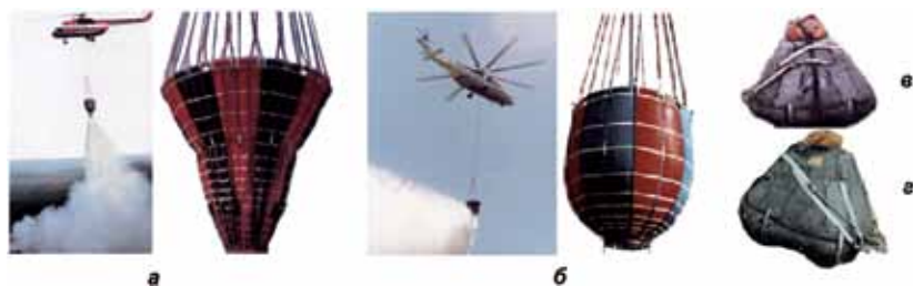
Рис. 9.15. Отечественные ВСУ и мягкие резервуары, применяемые для доставки воды по воздуху: а – ВСУ-5А (слева на подвеске Ми-8); б – ВСУ-15 (слева на подвеске Ми-26); в – П-1.00.М; г – П-1.00.Н
