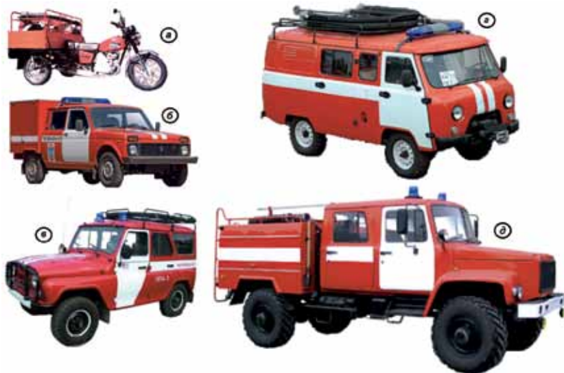
Рис. 9.8. Некоторые модели отечественных лесопатрульных комплексов: а – Иж 6.92001 (на базе Иж 6.920 ГР); б – АПС-0,1-0,5/30 (на базе ВАЗ-234612); в – ЛПА-3 (на базе УАЗ-31519); г – АНР(Л)-20 (на базе УАЗ-33036); д – АЦ(Л)-1,0-30-4ВР (на базе ГАЗ-3308)
