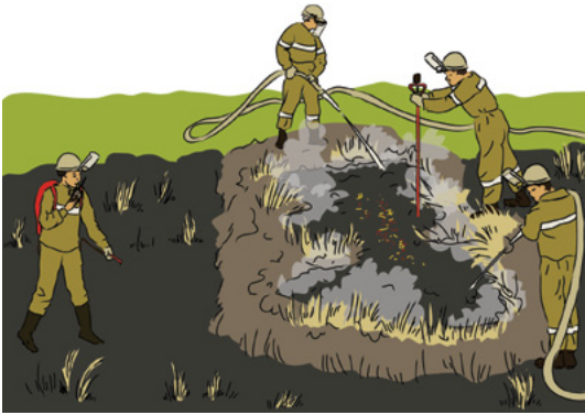
Рис. 16. Схема тушения торфяного пожара с помощью водопадающей техники и с использованием щупа-термометра.
