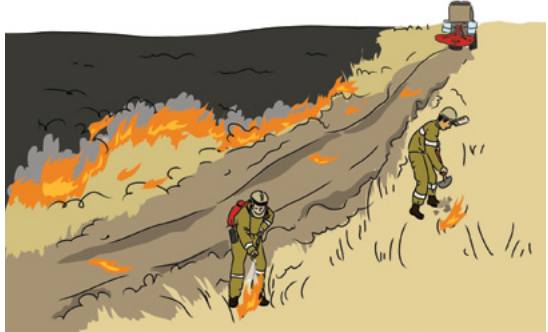
Рис. 4. Встреча степного пожара на минерализованной полосе с тушением перебросов (без проведения отжига) при косвенно-параллельном тушении.
