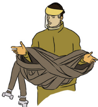
Рис. 28. Скатка рукавов к мото-помпе восьмёркой.
