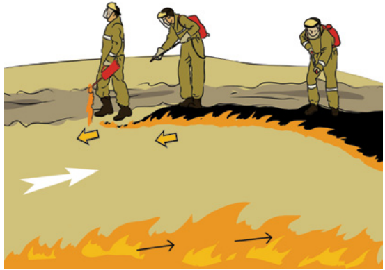
Рис. 15. Схема тушения отжигом по флангу пожара.
