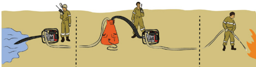
Рис. 29. Эстафетная подача воды к мотопомпе через промежуточную ёмкость и дополнительную помпу.
