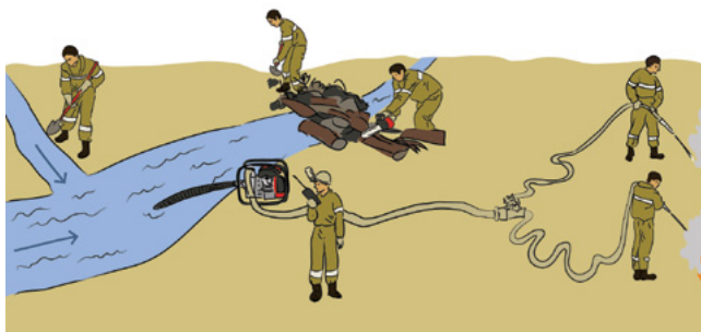
Рис. 26. Установка мотопомпы в мелкий проточный водоток.
