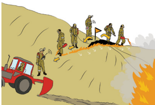
Рис. 13. Схема тушения отжигом по перевалу от опорной (заградительной) полосы.
