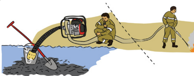
Рис. 24. Установка мотопомпы в мелкий водоём с грязью на дне.
