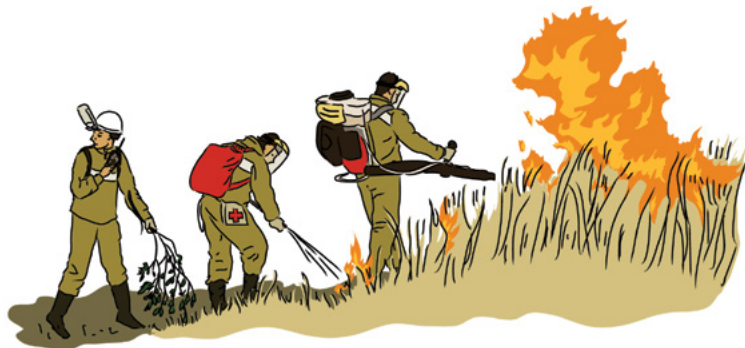
Рис. 22. Схема работы группы, оснащённой воздуходувкой, РЛО и средствами захлёстывания, на травяном пожаре.
