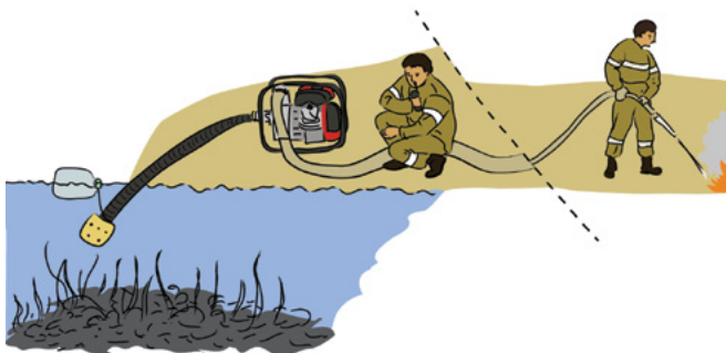
Рис. 25. Установка мотопомпы в глубокий водоём с грязью на дне.
